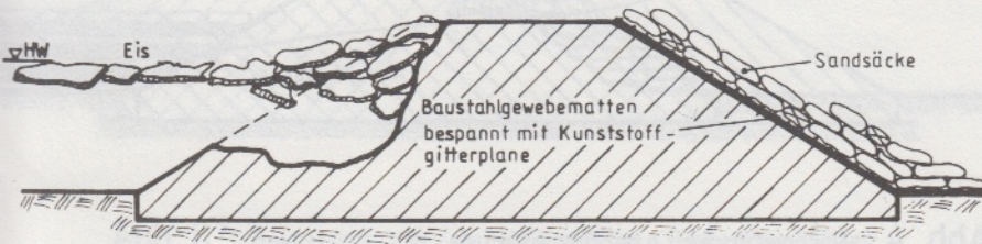
Abb. 11 Verstärkung der Binnendeichböschung mit Baustahlgewebematten und Sandsacklagen bei schwerem Außendeichschaden
