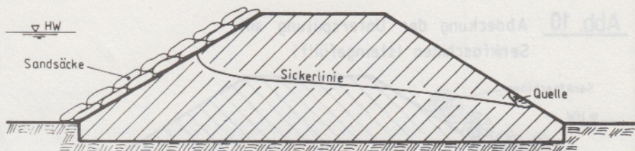
Abb. 2 Abdeckung der Quelleneintrittsstelle mit Sandsäcken
