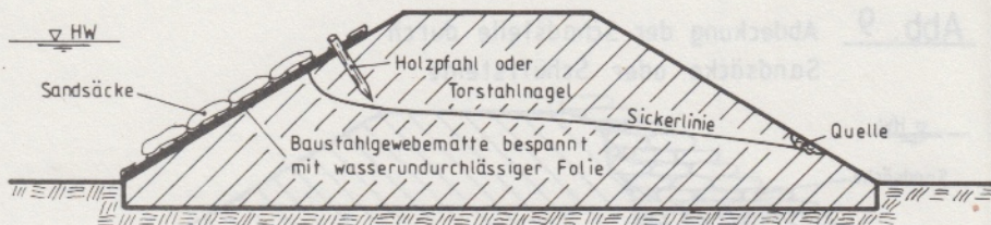
Abb. 1 Abdeckung der Quelleneintrittsstelle mit wasserundurchlässiger Folie auf Baustahlgewebematte
